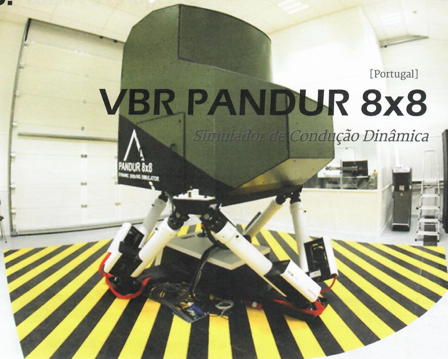
***O Pandur Dynamic Driving Simulator, é um sistema de simulação virtual, materializado num simulador de condução dinâmica da VBR 8x8 PANDUR, com a finalidade de aumentar a rentabilidade da formação e do treino, minimizando os custos de utilização dos equipamentos reais e reduzindo o risco de acidentes***
